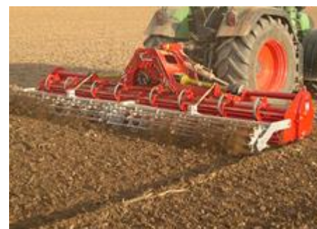
Etat de surface obtenu après le passage d'un rotavator équipé d'un rouleau cage Source : www.kongskilde.com
