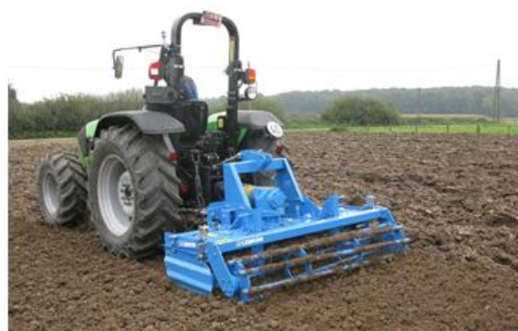
Herse rotative associée à un rouleau cage Crédit Photo : A. Aboudrare; Lemken, 2014
