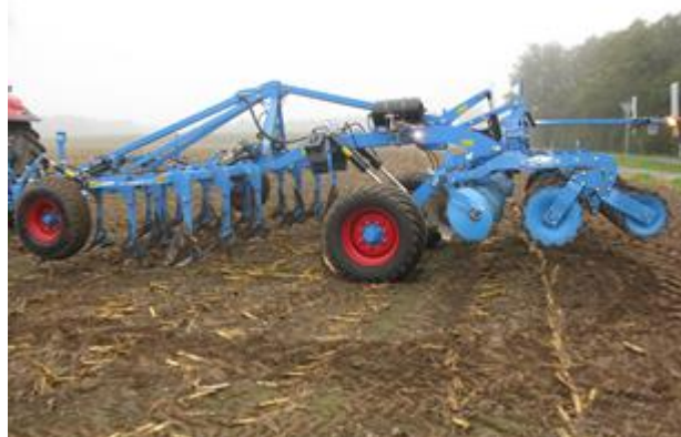
Outil à dents + train de disques + Rouleau
