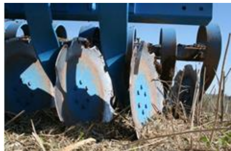
Déchaumeuse à deux train de disques Source : www.Lemken.com
