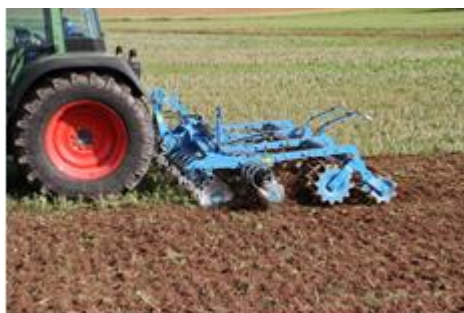
Déchaumeuse à deux train de disques Source : www.Lemken.com
