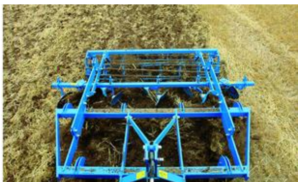
Etat de surface après passage d'une déchaumeuse à dents Crédit Photo: www.lemken.com
