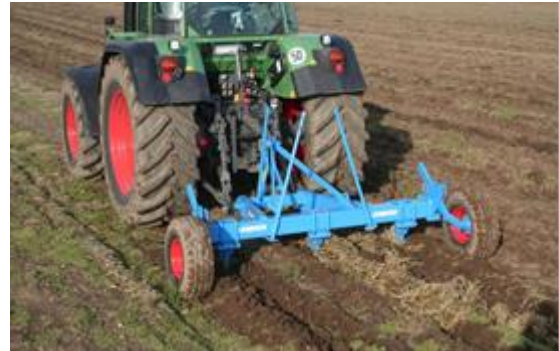
Etat de surface obtenu après passage d'un décompacteur Source : www.lemken.com
