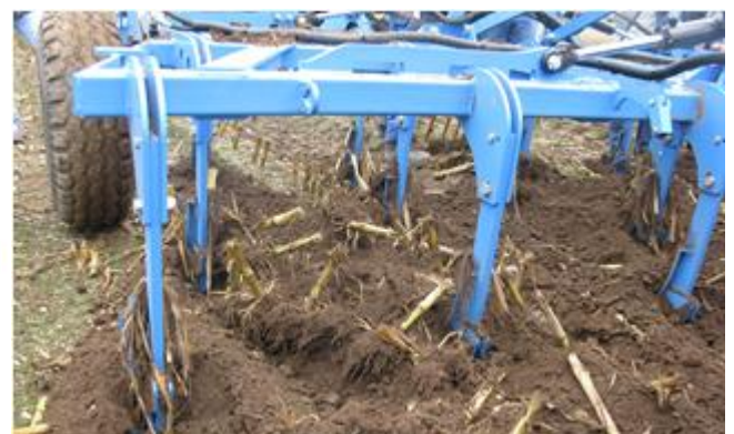
Mode d'action sur le sol des dents d'un cultivateur à dents Crédit Photo : A. Aboudrare; Lemken, 2014
