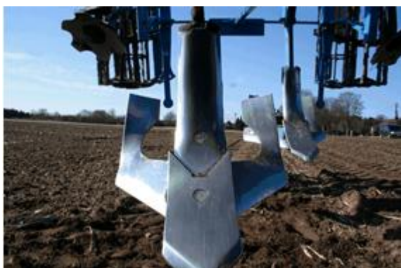
L'ajout d'ailettes apporte un effet de mélange de la masse organique avec la terre. Source: www.lemken.com
