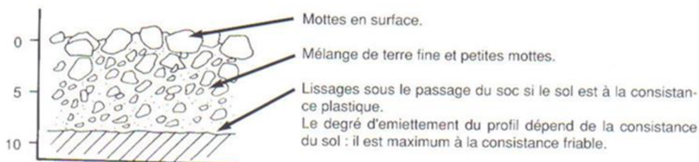
Schéma du profil du sol après passage d'un vibroculteur Source : ITCF
